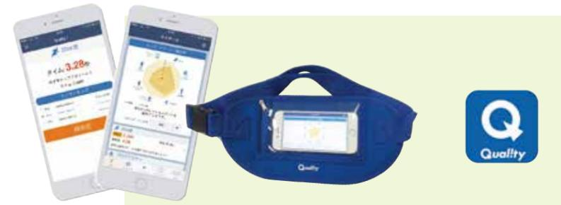
アプリ開発を手掛けるデジタル・スタンダードが、世界トップレベルのプログラマーと、発育発達やスポーツ医学の研究者とともにスマホだけで体力・運動能力の測定評価ができるアプリ「Quality」を開発した。2015年7月にリリースされて以来、特に、子どもや高齢者の体力測定シーンに浸透してきている。スマートフォンの進化で標準搭載されるようになった6軸センサーを活用し、専用ベルトに入れて装着するだけで体力測定が行える。測定値はクラウドに集積され、ビッグデータからの確かな評価やレコメンデーションを表示。運動やトレーニングに新たな気づきとモチベーションを提供する。
