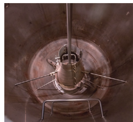
16基のタンクを上面発酵と下面発酵で使い分ける。5〜7日で主発酵が終了した段階の若ビールを貯酒タンクへ移動させ、ビールのタイプによって3週間〜3カ月程度、後発酵させる。
